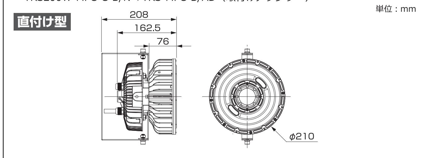
YRS-MPC-B/AD (取付けアダプター) 穴位置
