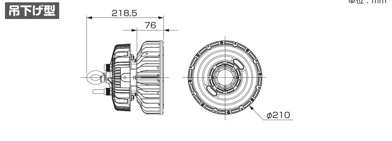
YRS200W-MPC-C-B/N + YRS-MPC-B/AD (取付けアダプター)
